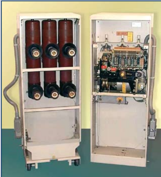
Vor Retrofitmaßnahme: 12-kV-Schaltwagen für Schaltfeld Typ ZE 5 mit ölarmen Leistungsschalter OD 3 .... 1250 A .... 25 kA Retrofit-Lösung hergestellt für ABB Utilities GmbH, Ratingen
