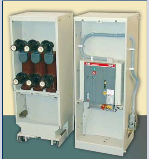
Nach Retrofitmaßnahme: 12-kV-Schaltwagen für Schaltfeldtyp ZE 5 mit Vakuum-Leistungsschalter VD 4 .... 1250 A .... 31,5 kA Retrofit-Lösung hergestellt für ABB Utilities GmbH, Ratingen
